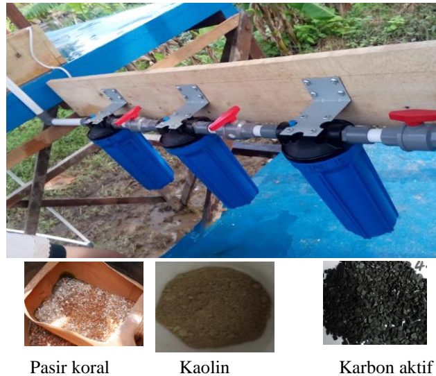
Gambar 3. Media Filtrasi dari Bahan Baku Lokal
