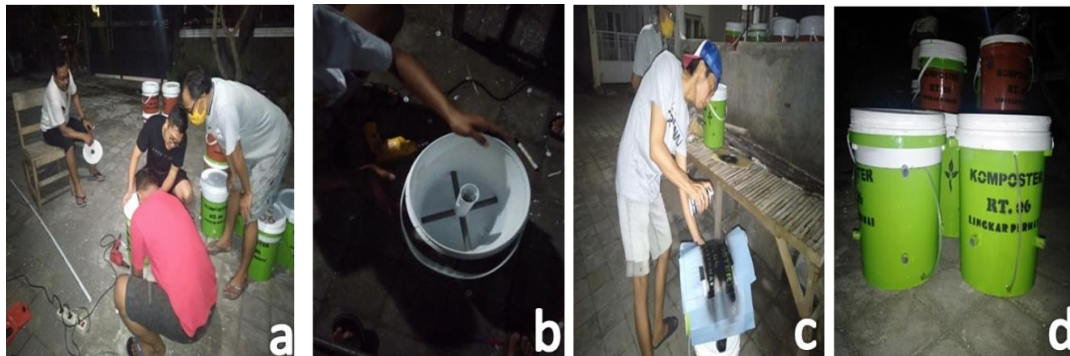
Gambar 2. Proses Pembuatan Komposter Sederhana dengan Memanfaatkan Ember Cat. a) Proses pembuatan, b) Bentuk Instalasi Bagian Dalam Komposter, c) Penyemprotan Nama, dan d) Komposter yang Sudah Jadi.
