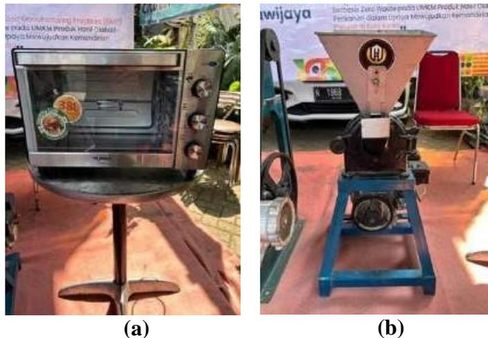
**Gambar 2 (a) Alat Pengering Tulang, (b) Alat Penggiling Tulang**
