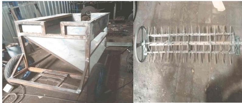
**Gambar 4 Pembuatan rangka dan perontok**
