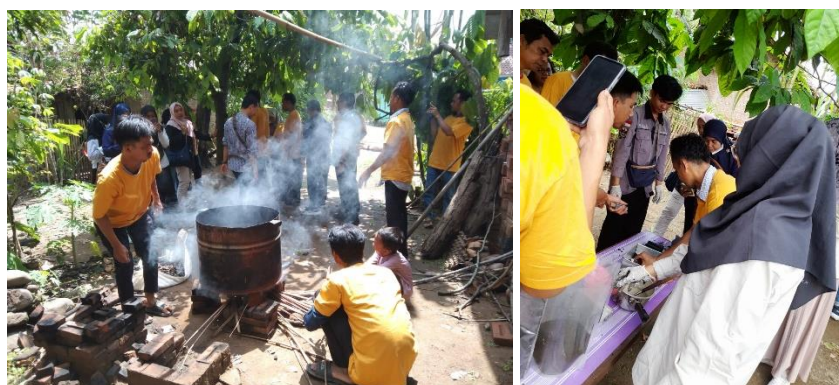
Gambar 5 Proses pengarangan, penggilinga, dan pencetakan briket cangkang kemiri
