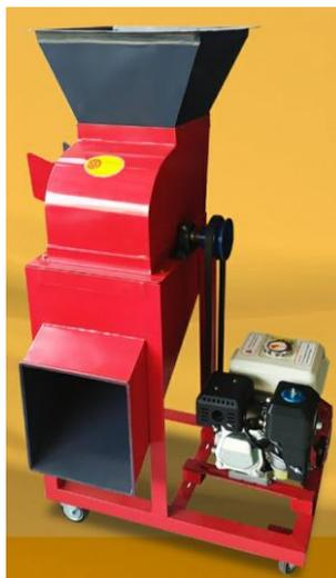
**Gambar 8 Mesin Pencacah Limbah Kelapa**
