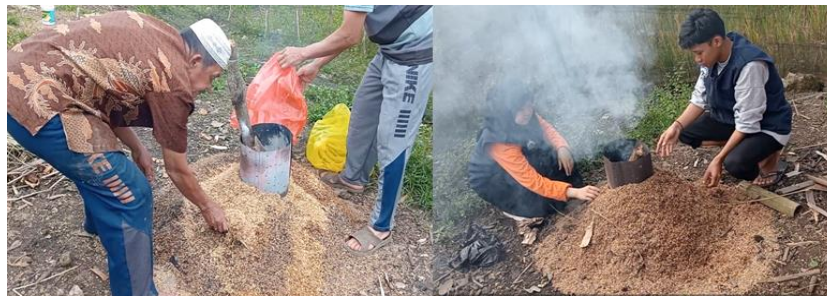
Gambar 4 Pembuatan Arang Sekam dari limbah padi
