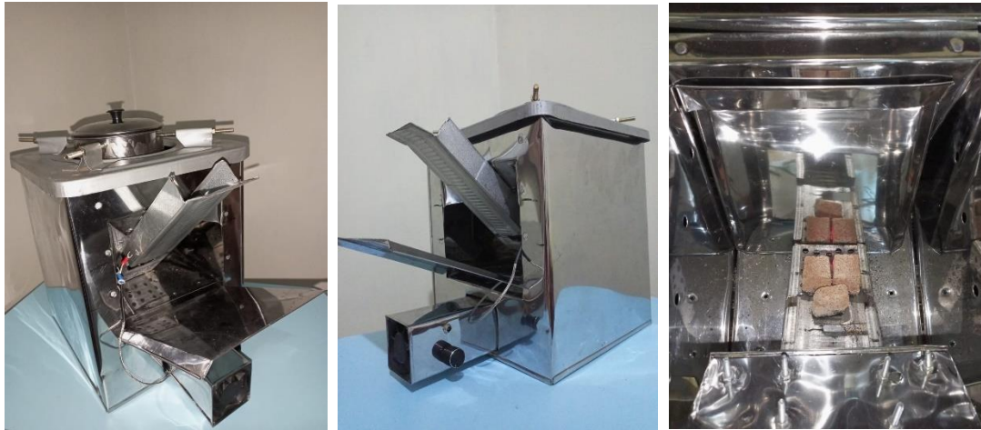
Gambar 2. Oven Annealing Kaca Tellurite Berbasis Mikrokontroler dengan Bahan Bakar Bio-Briket yang telah dimodifikasi.
