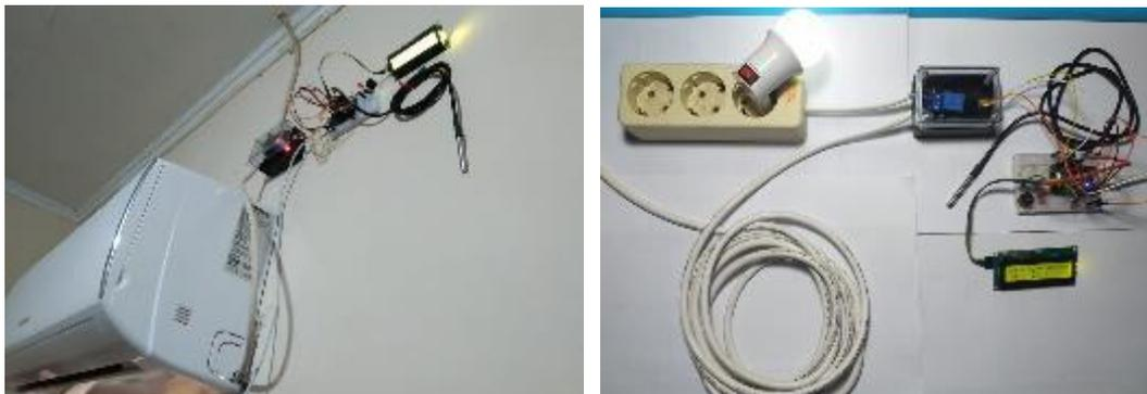
**Gambar 5 Alat Monitoring, Kendali Suhu dan Penerangan**
