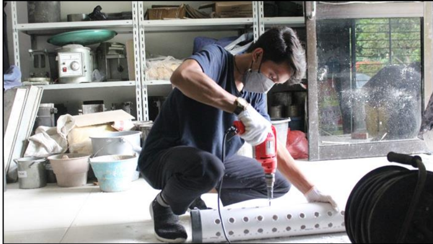
Gambar 3. Proses Membuat Lubang Pada Dinding Pipa
